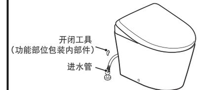
• 请确认进水角阀上已安装进水角阀盖。
