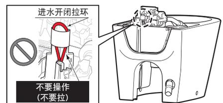
拉住进水拉环 (橙) 直到拉不动为止, 便器内的水可以切换「流入」和「停止」。
